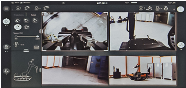
HOCHAUFLÖSENDE MULTI-TOUCH-SCREEN-GLEICHZEITIGE DARSTELLUNG MEHRER KAMERABILDER
